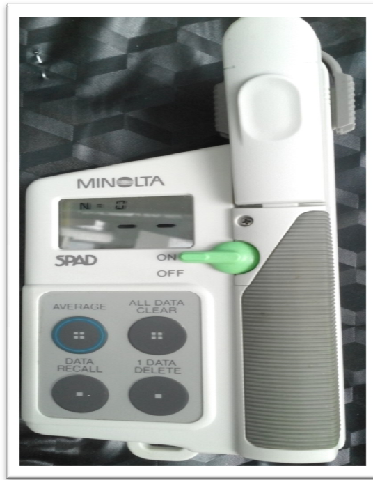
شكل 10: صورة تبين جهاز SPAD لقياس الكلوروفيل.
